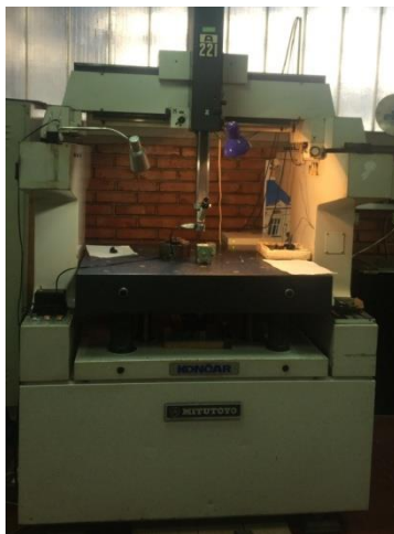
Слика 3. 3-координатна мерна машина (Mitutoyo A221, Japan).
