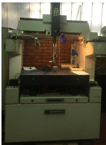
Слика 3. 3-координатна мерна машина (Mitutoyo A221, Japan).
