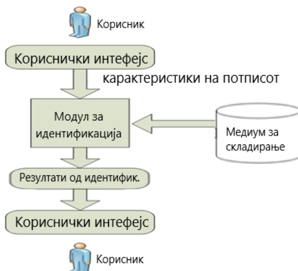
Слика 1. Блок дијаграм на системот за идентификација
